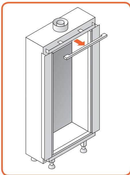
Fig. 10.3 - Rimozione della finitura alta
