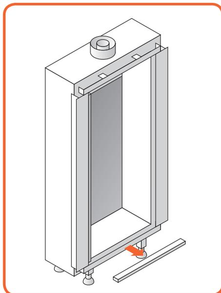
Fig. 10.5 - Rimozione della finitura bassa
