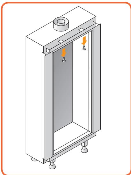
Figura 10.2 - Rimozione delle viti
