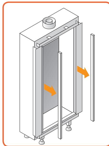
Fig. 10.4 - Rimozione delle finiture laterali
