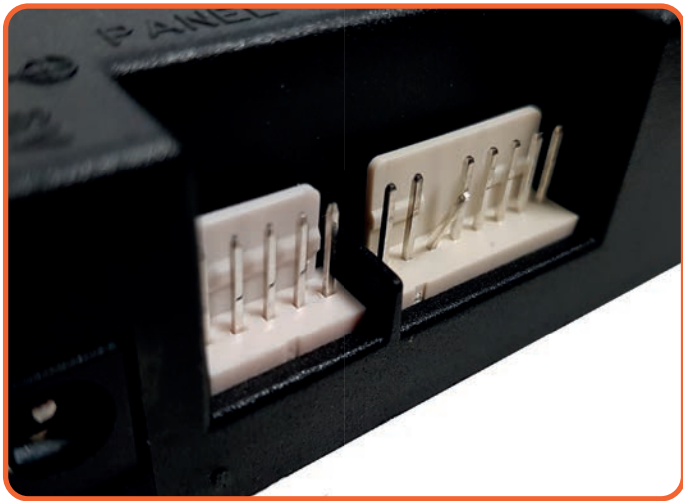
Figura A.1 - Spinotto piegato
