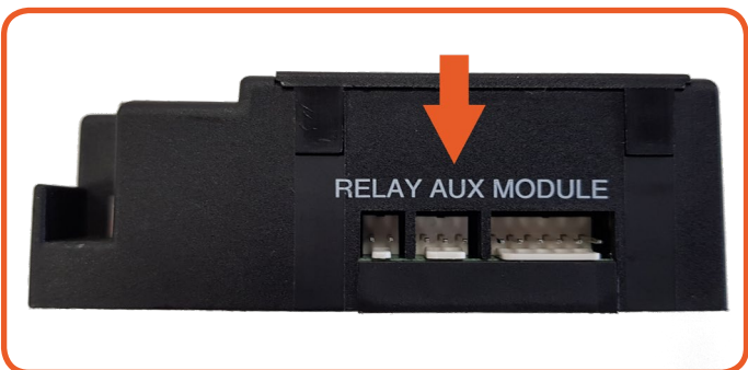
Figura A.11 - Posizione Aux ricevitore
